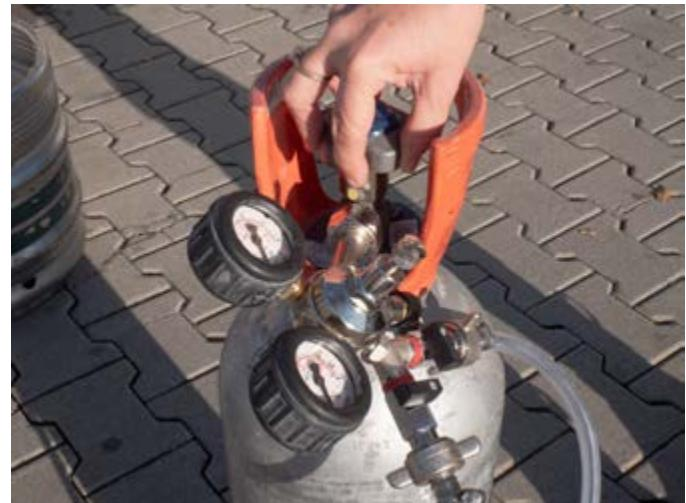
Den Kohlensäuredruck mittels der Stellschraubem auf ca. 2,2 Bar einstellen, indem Du diese nach rechts drehst. Die Anzeige dazu befindet sich auf der Oberseite am Co2-Druckminderer. Solltest Du ein Zischen feststellen, so prüfe bitte noch einmal alle Verbindungen.
